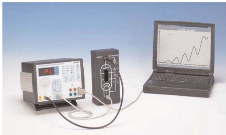
Gambar 3. Pengaturan percobaan Frank-Hertz dengan PC.
