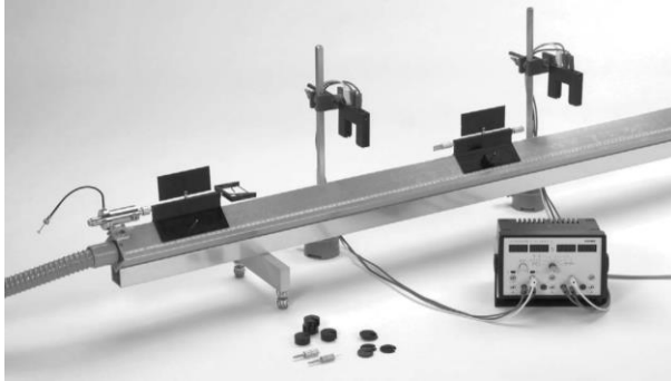
Gambar 2. Set-up percobaan tumbukan
