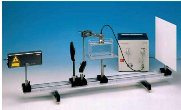
Gambar 3. Pengaturan percobaan untuk pengukuran interferensi.
