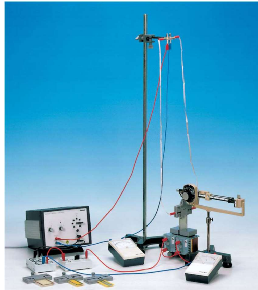
Gambar 1. Rangkaian percobaan: Timbangan arus: gaya yang bekerja pada konduktor membawa arus.
