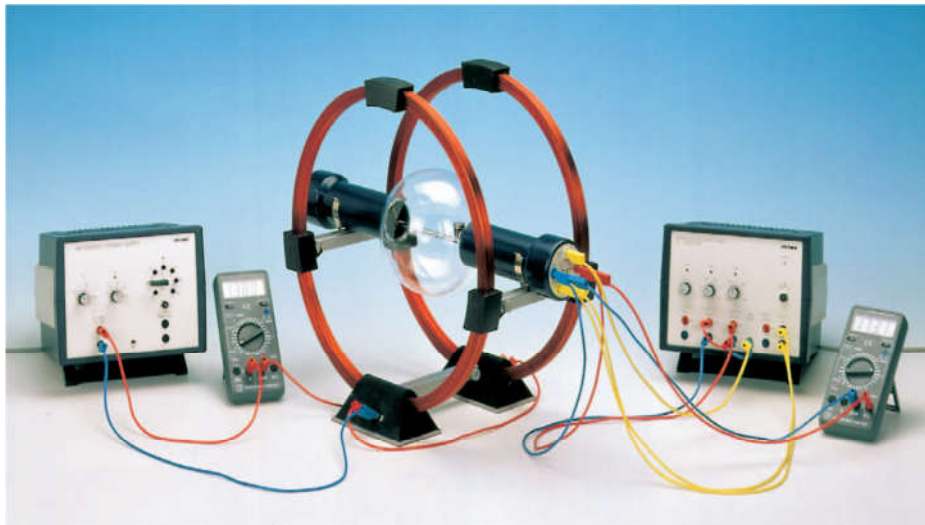
Gambar 3. Rangkaian alat percobaan untuk menentukan muatan elektron spesifik.
