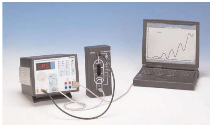
Gambar 3. Pengaturan percobaan Frank-Hertz dengan PC.
