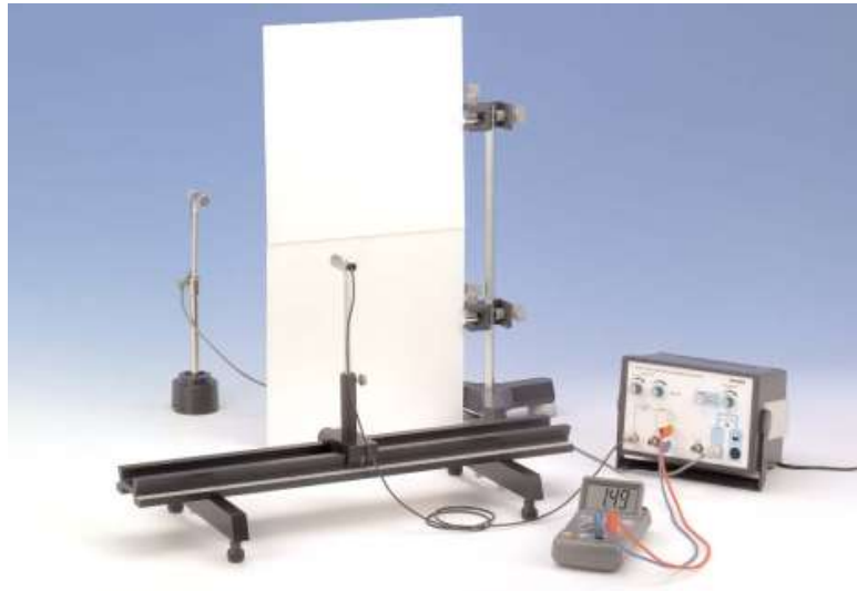
Gambar 3. Rangkaian alat percobaan difraksi gelombang ultrasonik oleh tepian lurus.
