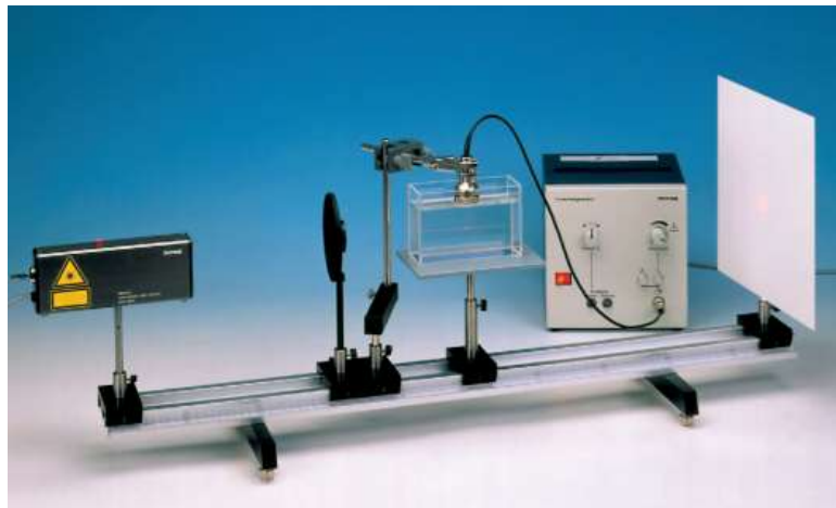
Gambar 3. Pengaturan percobaan untuk pengukuran interferensi.
